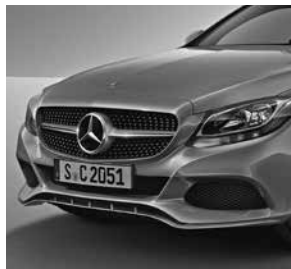
Buză pe fusta barei față
