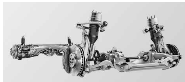
Suspensie sport AMG bazată pe AIR BODY CONTROL cu setare sportivă a amortizoarelor și arcurilor
